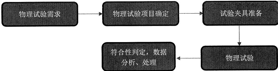
图5 物理试验简要工艺流程框图
